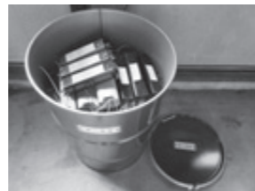
保管中の安定器 (PCB含まれる)
